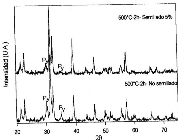
Fig. 5- Análisis por difracción de rayos X de muestras de gel sembradas y no sembradas calcinadas a temperaturas de  $500^\circ\text{C}$ -2h. Py (Pirocloro).
