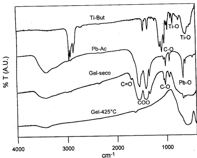
Fig. 1- Espectroscopía de IR. Espectros de  $Ti(C_4H_9)_4$ ,  $Pb(OCOCH_3)_2$ , Gel seco, y Gel calcinado a 425°C-10h.
