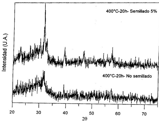
Fig. 3- Análisis por difracción de rayos X de muestras de gel semilladas y no semilladas calcinadas a temperaturas de 400°C-20h.
