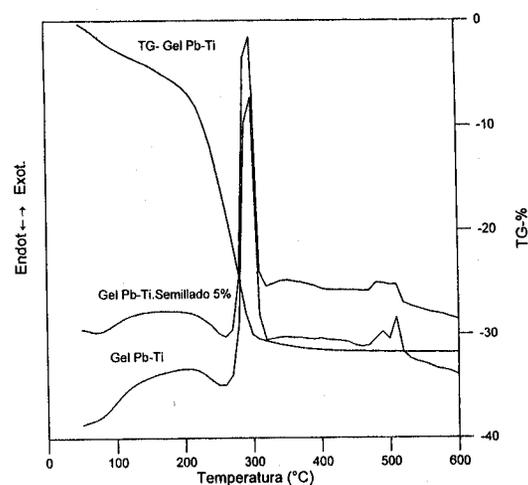
Fig. 2- Análisis térmico diferencial y termogravimétrico del gel semillado con un 5% en peso de partículas y el no semillado.
