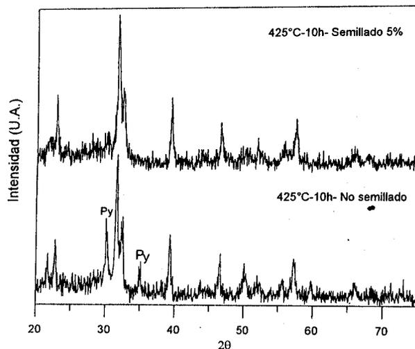
Fig. 4- Análisis por difracción de rayos X de muestras de gel semilladas y no semilladas calcinadas a temperaturas de 425°C-10h. Py (Pirocloro).
