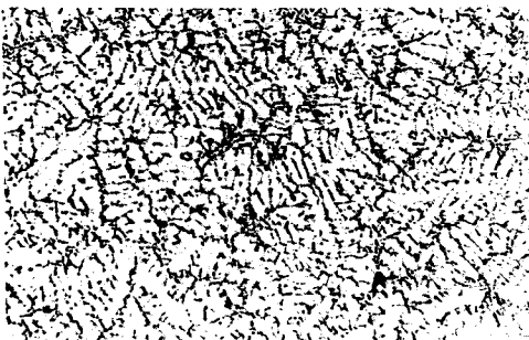
Fig.5: Dendritas de fase primaria obtenidas en la región central ( r = 0 mm) de la probeta experimental, (50X).
