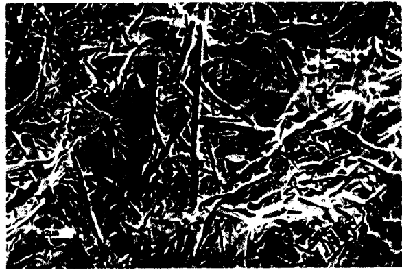
Fig. 2a. Micrografía de MEB de la superficie de fractura fresca del BIT
