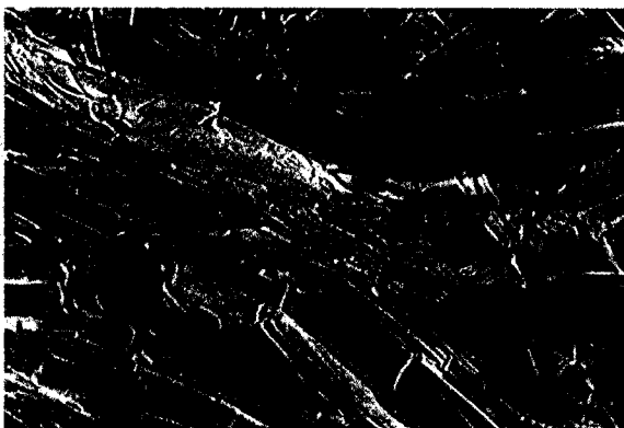
Fig. 4b. Microfotografía de la misma muestra que en la figura 4a, se observa que la distribución de electrones es homogénea en el interior de los granos.
