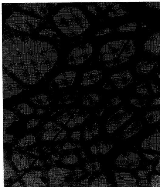
**Figura 1.** Nanoalambre de azufre visto con un microscopio electrónico de transmisión. Este nanoalambre fue obtenido empleando como molde óxido de aluminio nanoporoso con poros de sección transversal uniforme.
