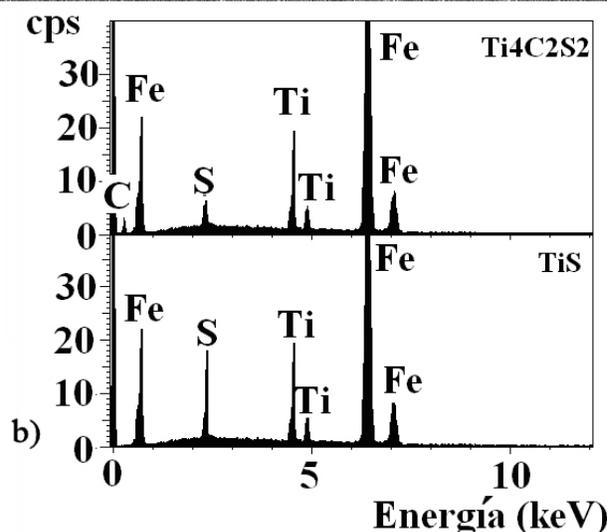
FIGURA 4. (a) Microestructura del acero en la condición de laminación en caliente ( $T_{Ini}$  1100°C,  $T_{Fin}$  850°C), en donde se identifican los precipitados (b)TiS y  $\text{Ti}_4\text{C}_2\text{S}_2$ .
