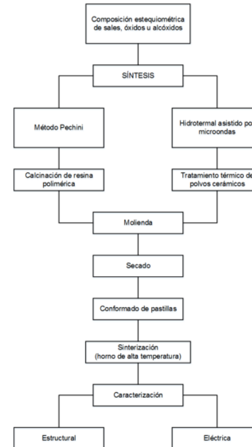
FIG 5. Diagrama de flujo del procesamiento usado en materiales cerámicos tipo BST x=0.15
