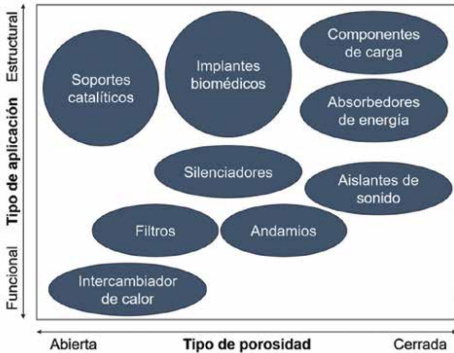
Figura 1.1. Aplicación de materiales con estructura celular en función del tipo de porosidad [4]
