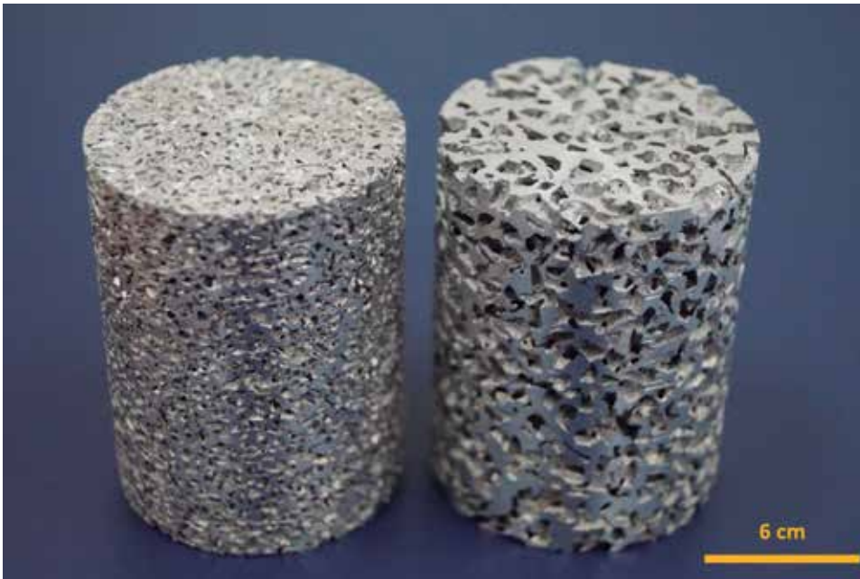
Figura 1.5. Espumas de aluminio con porosidad interconectada y diferente tamaño de poro, fabricadas por el método de colado por infiltración
